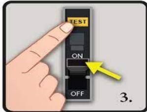
这点与 GFCI 类似，其测试可按 test 键。而复位操作：对于插座直接按 reset 键，而对于断路器，此时其手柄是处于中间位置的，应先将其扳到关的位置上，然后再扳到开的位置就可以了，切记：直接从中间位置是不能扳到开的位置上的。
