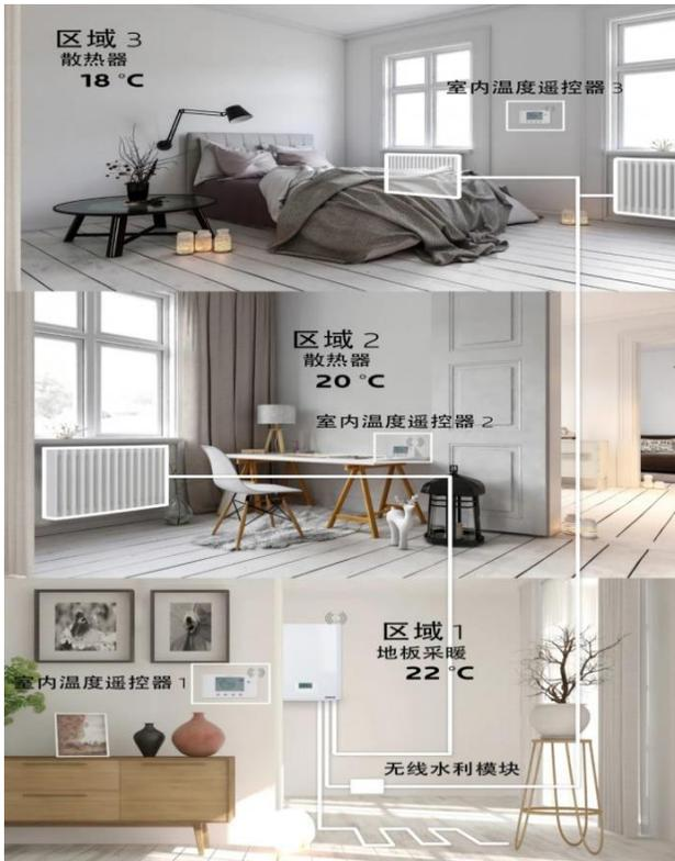
此功能使用了一些恒温器，先进的中央控制器，以及一系列的气流调节器，控制气流量的大小及热量的多少。每个房间都可以根据个人的需要，调节不同的温度，这比较适合于大家庭。
